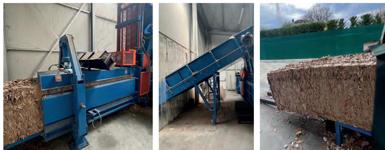
Pressa residui di imballaggi
